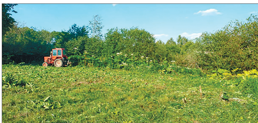
Рисунок 2. Удаление надземной части преимущественно борщевика Сосновского МТА Т-25+ ботвоудалитель цепной на опытном участке
